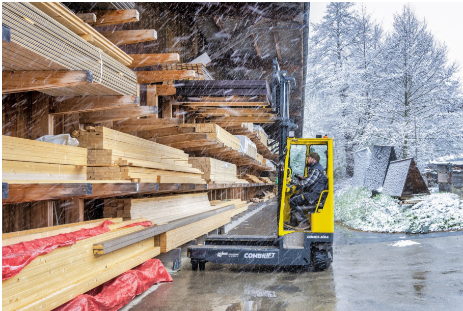
Mit dem MR4 sind Höhen von bis zu sechs Metern möglich
